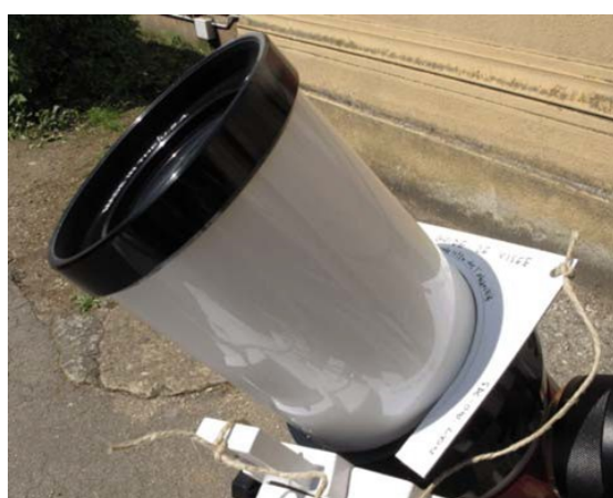
Figure 1 - centrage du Soleil par l'ombre de la collerette de l'objectif.
