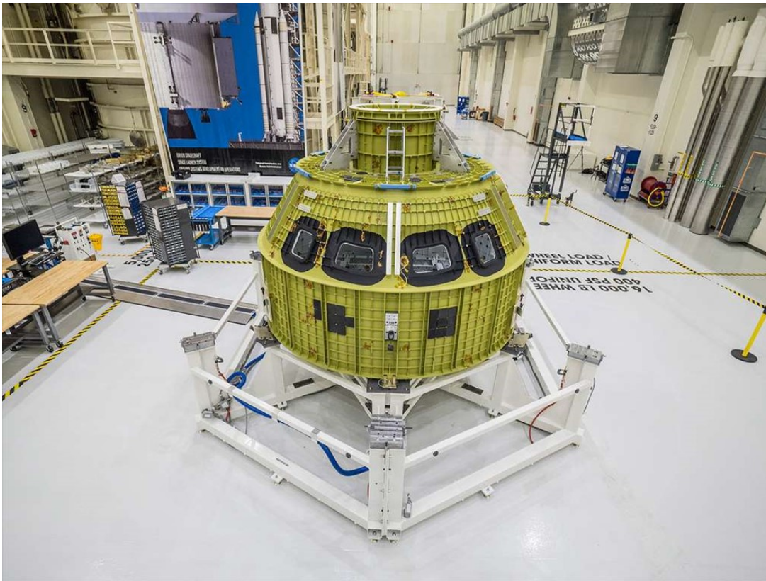
Le véhicule spatial Orion prend forme. À l'image, la structure sous-jacente du module d'équipage dans le Neil Armstrong Operations and Checkout du Centre spatial Kennedy.
