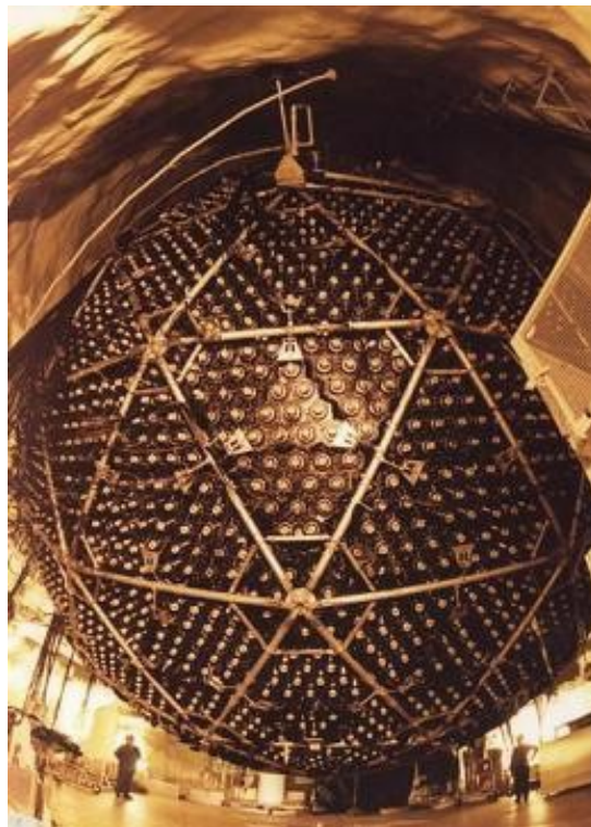
Le détecteur de l'observatoire de neutrinos de Sudbury au Canada pendant sa construction. Cet observatoire est opérationnel depuis 1999 et a pour but de contribuer à notre compréhension des propriétés fondamentales des neutrinos.
