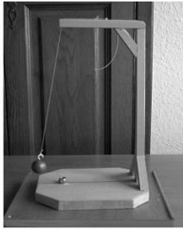
Figure II-3 : Un pendule monté sur une platine tournante permet de comprendre le principe du pendule de Foucault de manière saisissante. Quand la platine tourne, le pendule oscille toujours dans la même direction. Une personne placée sur la platine penserait que c'est le plan d'oscillation qui tourne.
