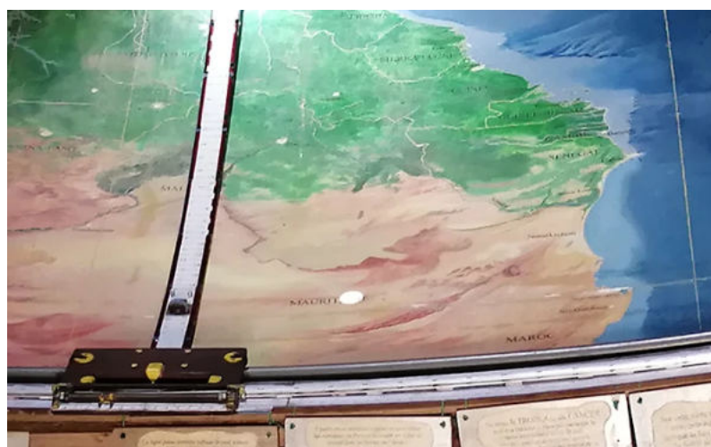
Fig. 4 – Position de l'image du Soleil sur la surface hémisphérique du scaphé 21 mai 2022 à 12 h 37 min 38 s UTC. Le Soleil était alors au zénith d'un lieu situé en Mauritanie dont la latitude correspond à la déclinaison du Soleil pour cet instant, soit 20^\circ 14' 33,879'' . Crédits P. Descamps/IMCCE
