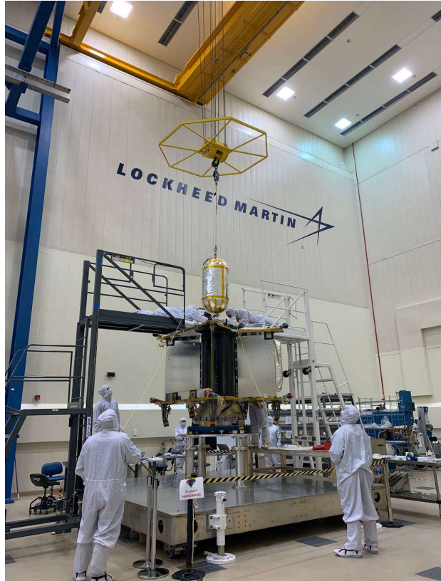
LES INGÉNIEURS INSÉRANT LE RÉSERVOIR DE PROPERGOL À L'INTÉRIEUR DE LA SONDE. © LOCKHEED MARTIN SPACE
