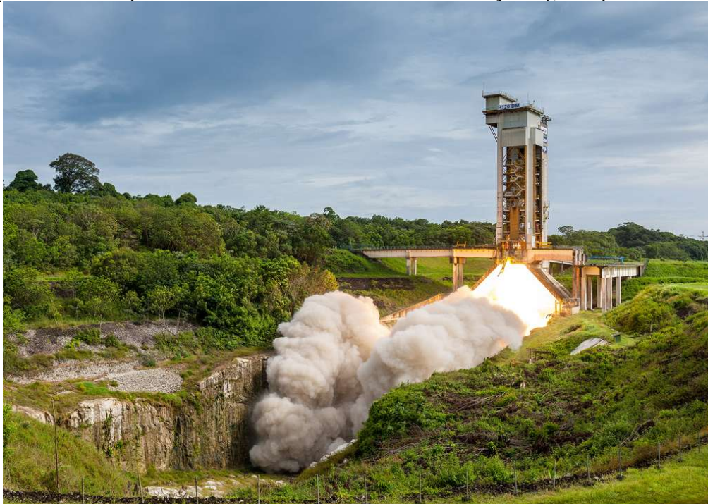
Le P120C, le plus gros moteur à propergol solide monolithique du monde testé avec succès sur le site du Centre spatial guyanais. © ESA, Cnes, OptiqueVideoCSG, JM Guillon
