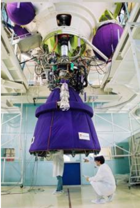
Vue du moteur Vulcain monté à la base du corps central de Ariane.
