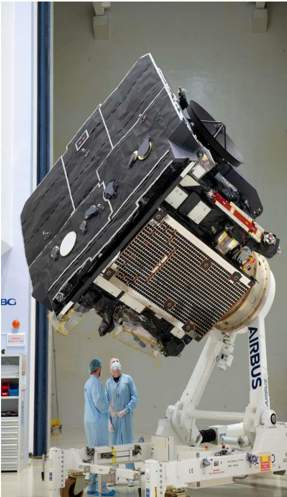
La sonde Solar Orbiter avec, au premier plan, son bouclier thermique conçu pour résister à des températures de plus de 500 °C. © ESA
